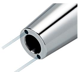
Nachträgliches Erodieren von 2 Kühlkanalbohrungen
