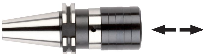
**Radialer Pendelausgleich** – gleicht eine geringe Abweichung der Maschinenspindel-Achse und der Bohrungssachse aus. Dieses sollte möglichst vermieden werden.
