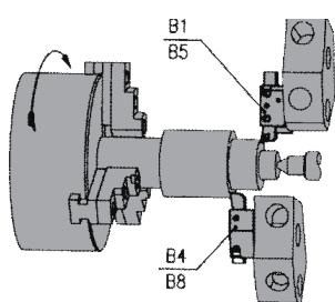
Einsatz von Radial-Werkzeughaltern bei rechter Spindeldrehrichtung
