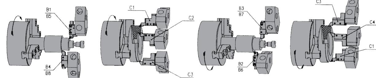
Einsatz von Werkzeughaltern bei linker Spindeldrehrichtung
