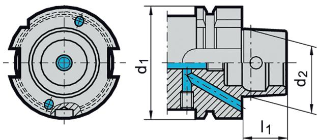
Pour les lignes de transfert, les machines spéciales et les systèmes d'outils modulaires. Cône à tige creuse pour le changement d'outil manuel. Actionnement par un trou d'accès dans le cône. Comme tous les porte-outils de forme A sont équipés de trous latéraux pour le changement manuel d'outil, ils peuvent également être utilisés comme porte-outils de la forme C. Le couple est transmis par adhérence et par liaison de forme.
