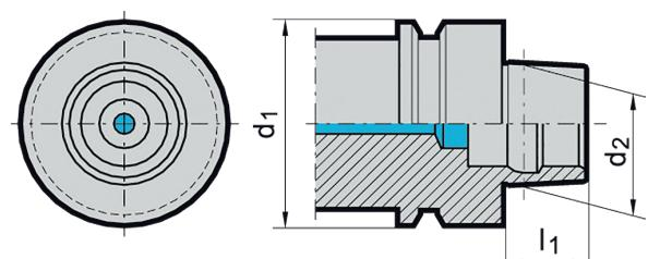
En cas d'usinage avec refroidissement interne, les attaches HSK de la forme A doivent être équipés d'un tube de refroidissement.
