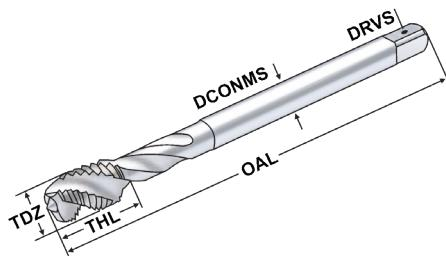
1. Gewinde in spezieller Ausführung, verhindert zu großen Vorschub, dünnes Gewinde und zu große Steigung.
