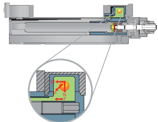
Durch das neue Anti-Lift-System werden die Werkstücke beim Spannen niedergezogen und präzise gespannt
