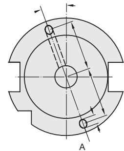
**Werkstoff:** Legierter Einsatzstahl mit einer Zugfestigkeit im Kern von min. 950 N / mm<sup>2</sup>.
