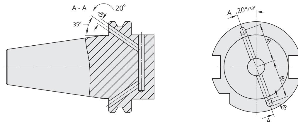
**Werkstoff:** Legierter Einsatzstahl mit einer Zugfestigkeit im Kern von min. 950 N / mm<sup>2</sup>.
